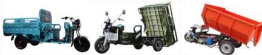
Triciclos con área de carga abierta y de volteo para podas
