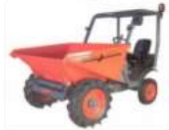
Motovolqueta con área de carga abierta, frontal y de volteo apropiado para podas, escombros, lodos, compost.
